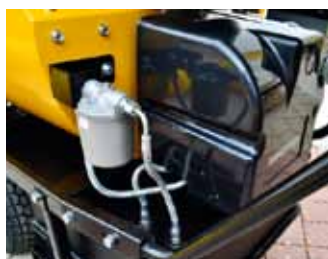
Grijač dobiva gorivo iz spremnika koji se nalazi ispod njega, a ima mogućnost spajanja na vanjski spremnik. Filter goriva je s vanjske strane. Predgrijač goriva je unutra, uz glavu plamenika.
