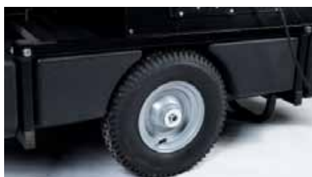
Robustan, rotoukalupljeni spremnik goriva i veliku pneumatski kotači.
