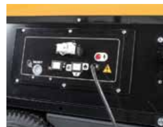
Upravljačka ploča sa utičnicom za termostat (analogni ili digitalni)
