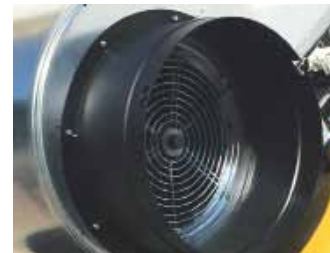
Jednostavna recirkulacija zraka – koristi 2 crijeva od Ø 30 cm
