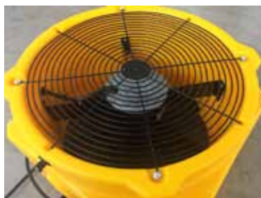
DFX 20 aksijalni ventilator. Ventilator može biti postavljen u 8 različitih položaja.
